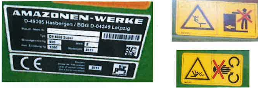
Imagen 3. Placa de identificación de características y advertencias de seguridad
